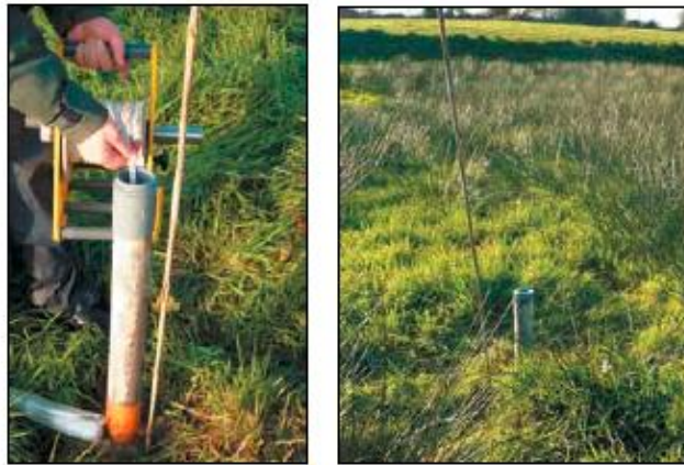
Figures 1 et 2 : piézomètre.
